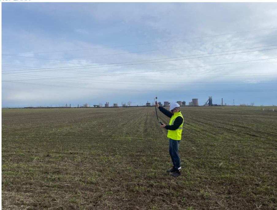
Foto 6.3. Prelevare și măsurare probe de aer – imisii: pulberi în suspensie (PM 10 )
