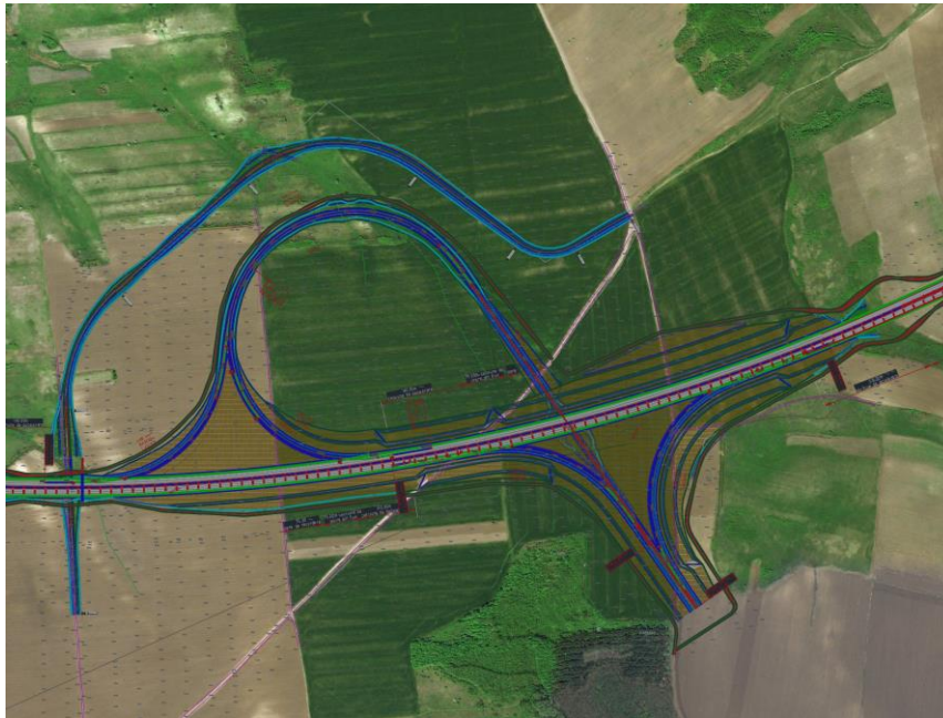
Figura 1.11. Nod rutier de perspectiva pentru conexiune cu drum de legătură la aeroportul Iași și Spitalul Regional Iași - km 82+210
