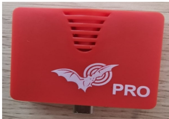
Foto XIII.7 Dispozitiv Echo Meter Touch 2 Pro
