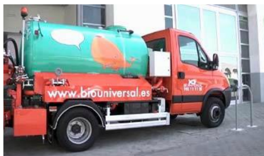
Figura 7-19 Tipuri de camioane și furgonete pentru transportul uleiurilor uzate din punctele de colectare
