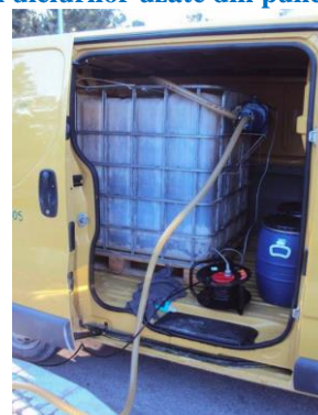
Figura 7-19 Tipuri de camioane și furgonete pentru transportul uleiurilor uzate din punctele de colectare
