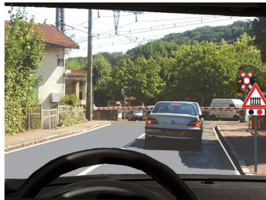
Figura 34: Exemplu de trecere la nivel cu calea ferată amenajată corespunzător (Sursă: Manual de siguranță rutieră pentru Rep. Moldova. Administrația de Stat a Drumurilor, 2011)
