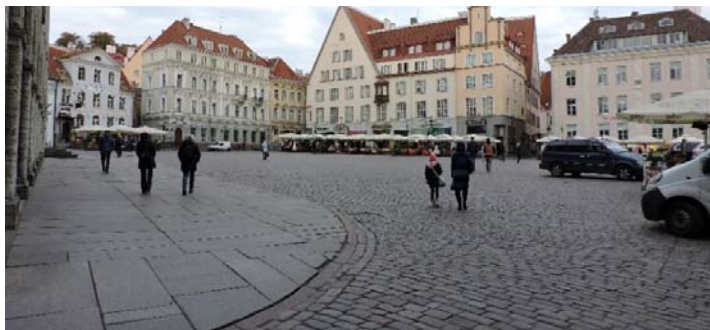
Figura 135: Exemplificări bune-practici: Spații “utilizate în comun”, partajate (“shared-space”), cu o slabă diferențiere a carosabilului și circulației pietonale (nivel comun, textură asemănătoare deși sesizabil diferențiată), în zone centrale și/sau comerciale sau de agrement
