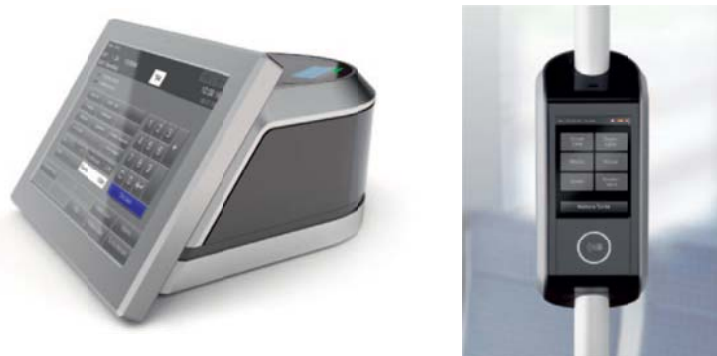
Figura 115: Exemple pentru dispozitive la bord (validator bilete, validator pentru E-Ticket) Sursa: IVU Traffic Technologies
