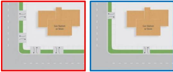
Figura 12: Exemple de reamenajare a acceselor prin comasare (corect în dreapta) (Sursă: Los Angeles County: Model Design Manual for Living Streets, 2011)
